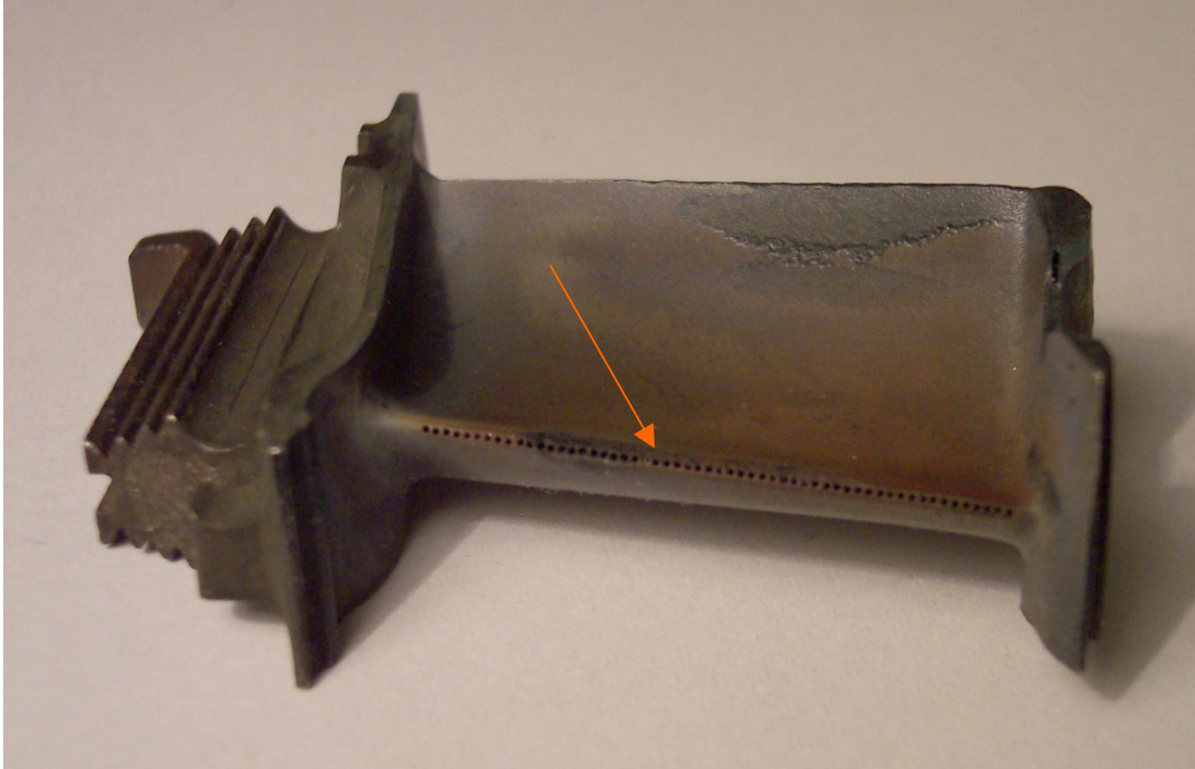
Bild 1: im Prinzip vergleichbare Turbinenschaufel mit Bohrungsreihe (Pfeil) Die Materialschwächungen im Mantel können mit der Durchstrahlungsprüfung nachgewiesen werden.
