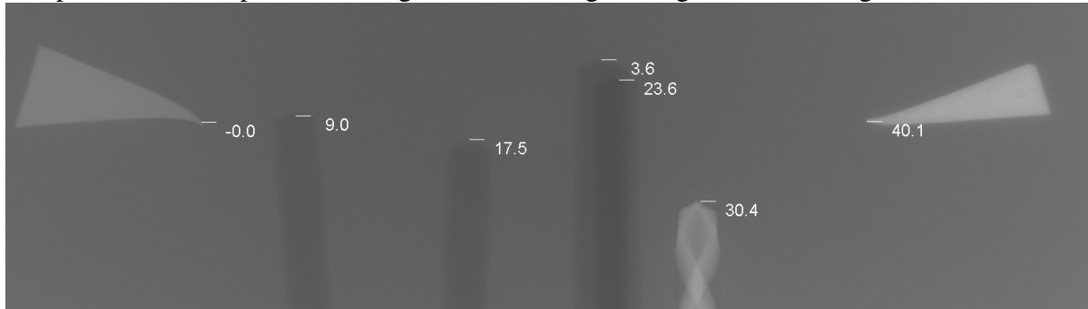
Bild 3: Auswertungsbeispiel der Fehllertiefen (die Angaben erfolgen hier in mm – bezogen auf die Oberfläche der Filmfernen Objektseite.)
